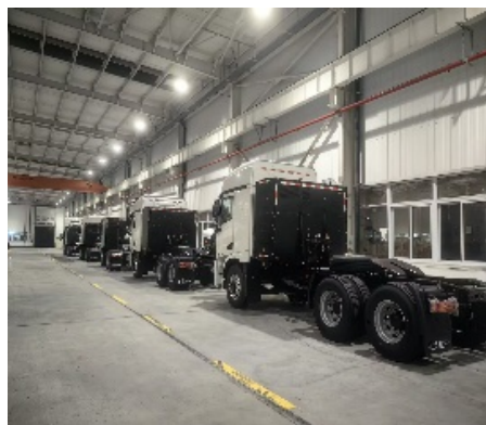
图 7：后背电池安装
