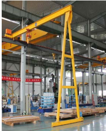
图 5：侧置式电池起吊起重机
